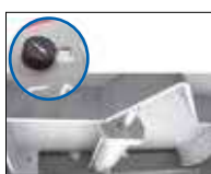
Bloqueo neumático de las plataformas móviles traseras.
